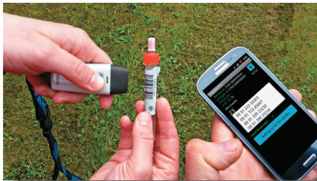
**Abb. 2:** Software „HIT-Scanner“ auf einem Smartphone, Bluetooth-Scanner und barcodiertes Blutröhrchen
