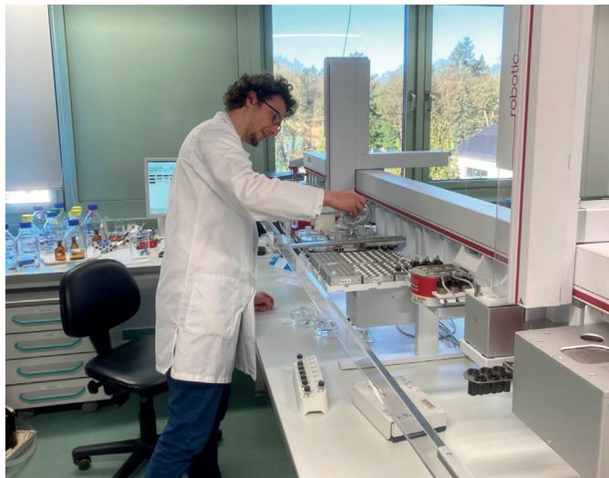
Teilautomatisierte Probenvorbereitung in der Pflanzenschutzmittelanalytik im LALLF
