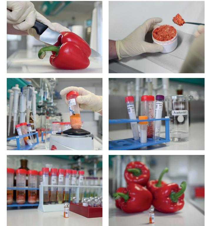
Von den 0,5 kg bis 2 kg, die je nach Lebensmittel als Probe angefordert werden, kann nach Homogenisieren eine repräsentative Teilprobe abgewogen werden. Zusammen mit Acetonitril als Lösungsmittel sowie verschiedenen Salzen zur Aufreinigung wird die Probe stark durchgemischt und nach anschließendem Zentrifugieren der Überstand als Messextrakt abgefüllt.
