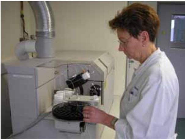
ICP-MS zur Bestimmung von Aluminium
