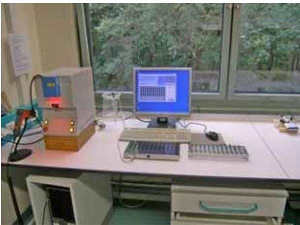
*Arbeitsplatz mit Öffnungsautomat für Ohrstanzproben, Detektorplatte zum Aufnehmen der Proben, Software zum Scannen der Ohrmarkennummer*
