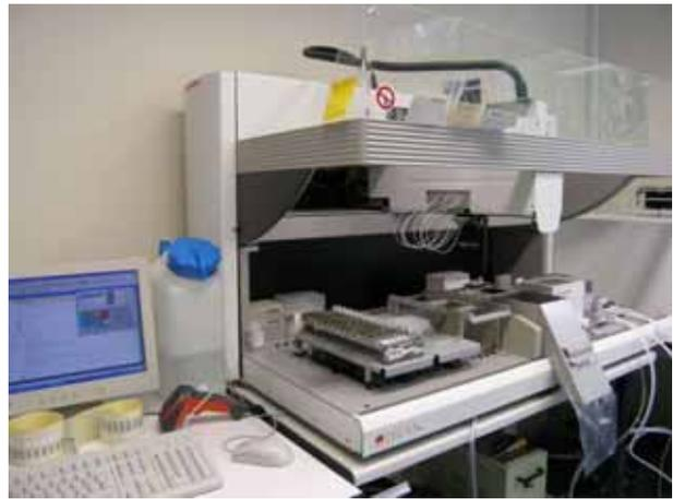
*Pipettierautomat zum Vorbereiten der Proben für die PCR*
