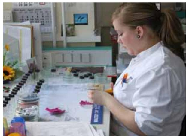
Vorbereitung der eingesendeten Proben, Zerkleinern von Textilien
