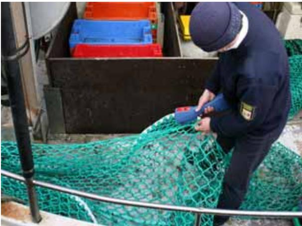
*Fischereiinspektor beim Messen der Maschenöffnung mit dem OMEGA-Gerät*
