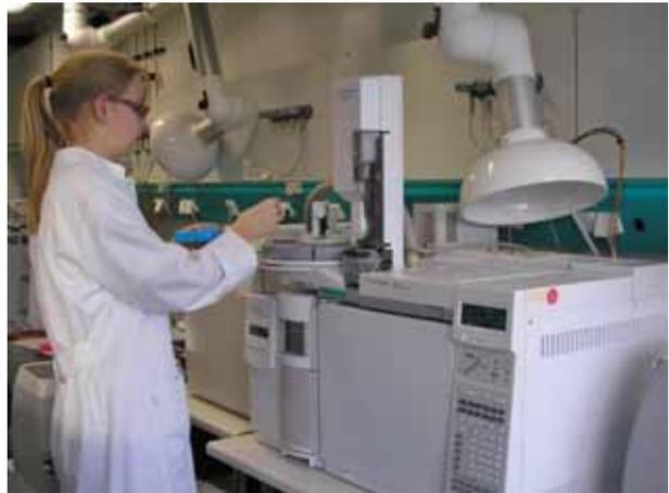
*Untersuchung von Organozinnverbindungen mittels Gaschromatografie und massenselektiver Detektion durch eine Auszubildende*
