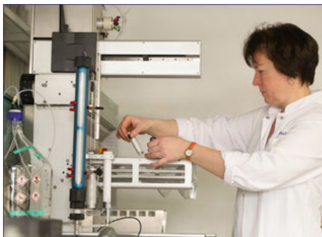
Bestücken eines FREESTYLE-Systems GPC zur Probenvorbereitung
