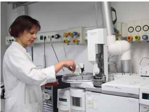
Futtermittelprobenplatzierung in ein GCMS (Gaschromatografie-Massenspektrometer-System) im LALLF, Abteilung "Rückstandsuntersuchungen"
