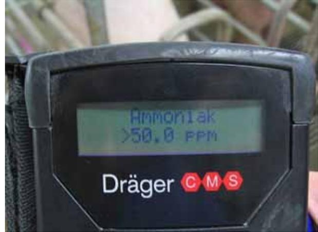
*Einzelpunktmessung mittels Chip-Mess-System (CMS) im Schweinestall zur Kontrolle von Grenzwerten*
