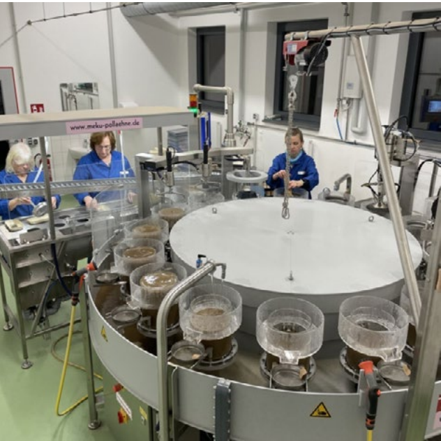
Abbildung 1: Nematodenkarussell zur Aufbereitung größerer Mengen an Bodenproben in der Nematologie
