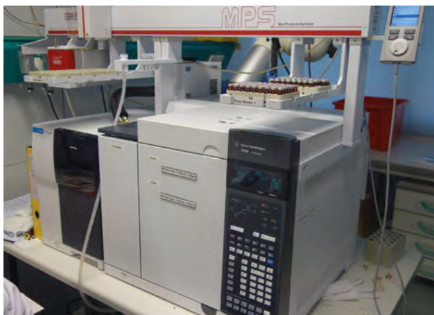
GC-MS zur Untersuchung von Phthalaten
