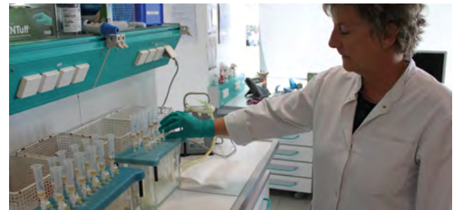
Festphasenextraktion zur Matrixabtrennung für die Bestimmung von Aminoglycosiden
