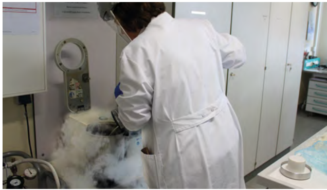
Cryomilling mit Flüssigstickstoff zum Homogenisieren von frischem Obst und Gemüse
