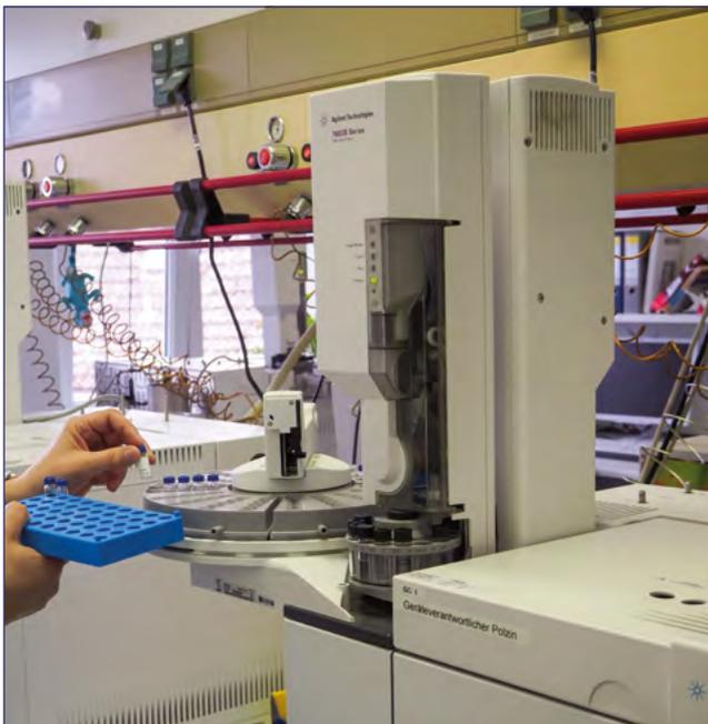
Einstellen der Proben in den Gaschromatographen
