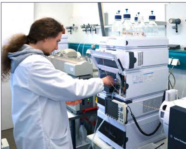
Ein LCMS wird mit Proben zur Bestimmung von PA in Honig bestückt
