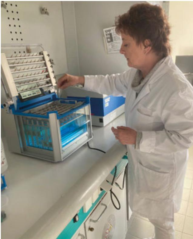
TurboVap-Gerätevorbereitung (automatische Eindampfstation zum Einengen bzw. Abblasen von Lösungsmitteln)
