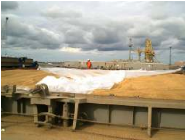
Abb. V-11: Vorbereitung einer Begasung insektenbefallener Getreidestapel auf einem Schiff
