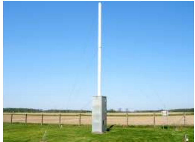
Abb. VII-5: Saugfalle zur Ermittlung von Artenspektrum und Flugverlauf der Blattlauspopulation
