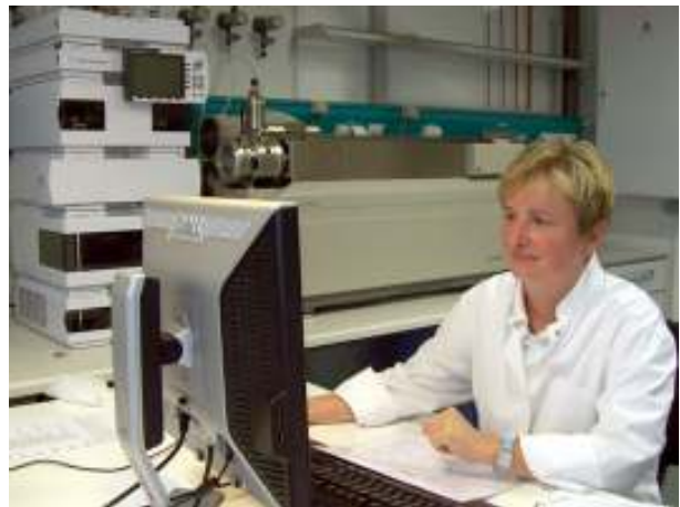
Abb. V-17: Spezielle Rückstandsuntersuchung auf Tierarzneimittel am LC-MS/MS
