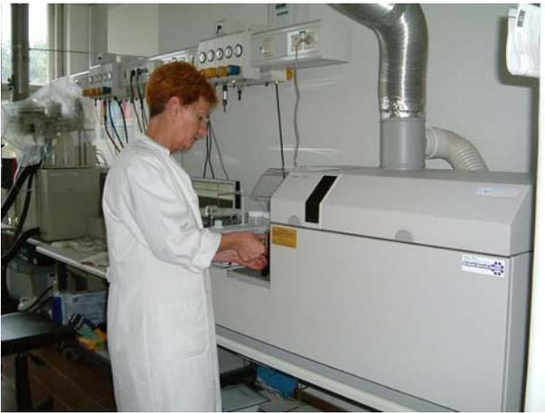
Abb. III-4: Untersuchung von Mineralwasser mittels ICP-MS
