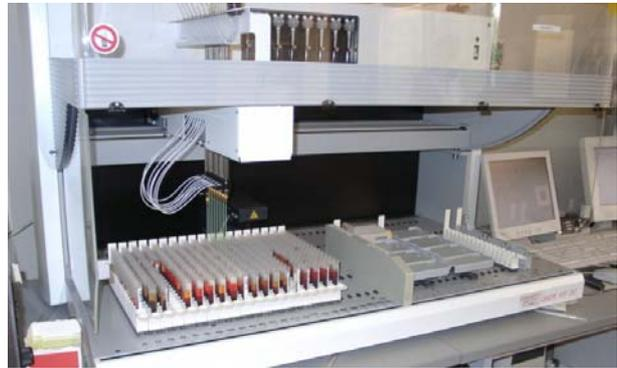
Abb. II-1: Pipettierroboter zur Bearbeitung von Blutproben
