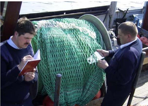
Abb. I-2: Prüfung der Maschenöffnung bei Fanggeräten
