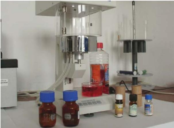
Abb. III-16: Tensiometer zur Messung der Oberflächenspannung und Dichte von Ölen
