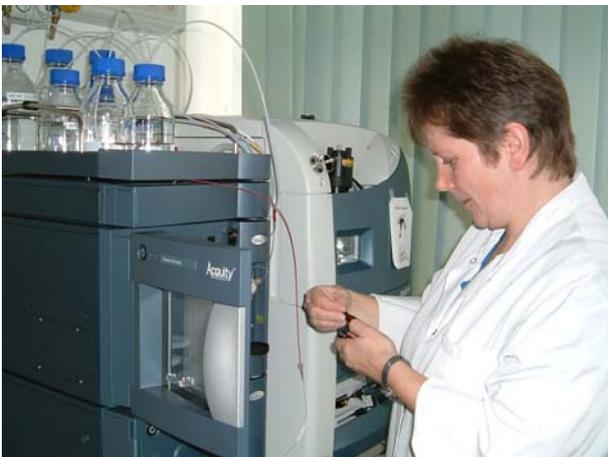
Abb. III-9: Bestimmung von pharmakologisch wirksamen Stoffen mittels LC-MS/MS
