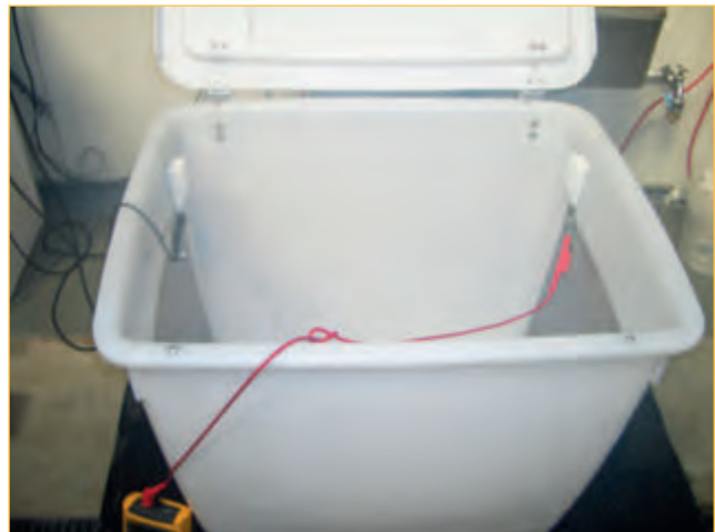
Beispiel einer elektrischen Betäubungsanlage für Aale
